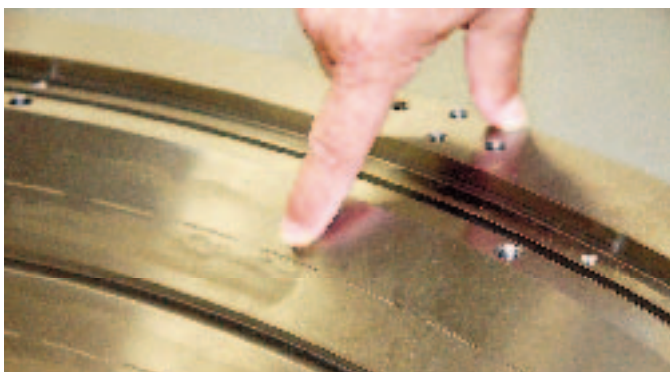
Diese Taschen werden auf der Kehren ausgefräst, und anschliessend wird eine 0,25 mm kleine Bohrung gebohrt. Im rechten Bild die Vergrößerung, aber der SMM-Redaktor konnte die Bohrung beim besten Willen nicht erkennen. Diese Ringe sind Luftlagerungen für Bearbeitungen im Halbleiter-Sektor.
